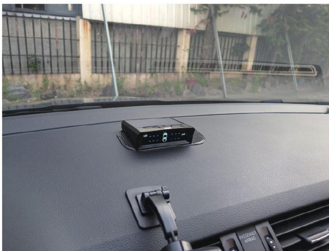
**注意：接收顯示器需擺放在前擋風玻璃下方，才能確保接收顯示器能接收太陽光充電並確保四輪位置學習正確。**
