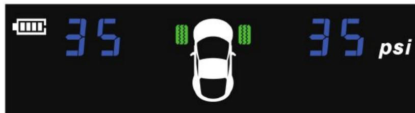
**後輪標準胎壓值設定**：設定範圍24psi~80psi (1.7bar~5.5bar)，出廠預設值為35psi (2.4bar)。
